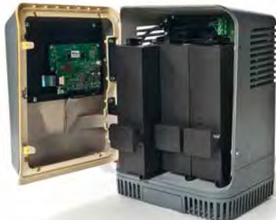
interno del cabinet a 3 slot
